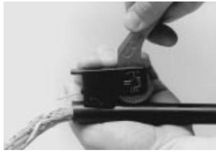
2 Для монтажа провода непрерывности экрана от среза оболочки в сторону кабеля сделайте ручным инструментом два продольных разреза оболочки. (Длина разрезов 20 мм, расстояние между ними 10 мм).
