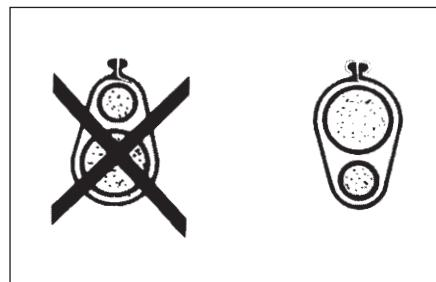
**15** При разветвительных соединениях термоусаживаемую манжету следует накладывать таким образом, чтобы клапан с клейким слоем, перекрывающий шов, и рельсы застежки находились над самым большим кабелем. (См. рисунок).
