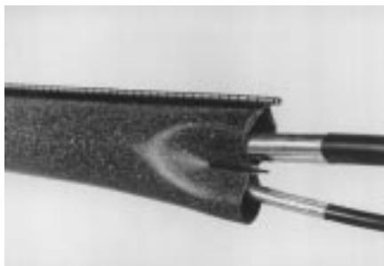
**17** Вставьте разветвительные зажимы между кабелями и надвиньте их на муфту до упора. Пережимайте зажимом муфту пропорционально диаметрам разветвительных кабелей.
