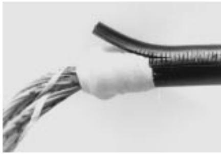
3 Подложите хлопчатобумажную или поливинилхлоридную ленту под полоску оболочки кабеля (см. рисунок). Соедините проводники кабеля, следуя обычной методике сращивания.
