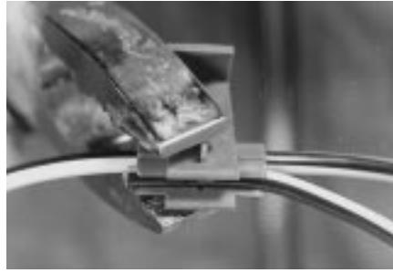
5 Для муфт с выводом 3-х и более кабелей с помощью обжимного соединителя подключите дополнительный провод к основному проводу обеспечения непрерывности экрана.
