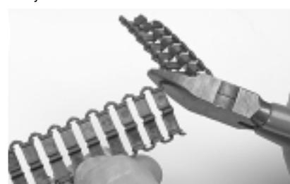
7 Обрежьте зажимающую ленту на необходимую длину. Цифры, напечатанные на зажимающей ленте, облегчают процесс отрезки ленты по требуемой длине. Для каждого кабеля необходимы 2 набора зажимающей ленты.
