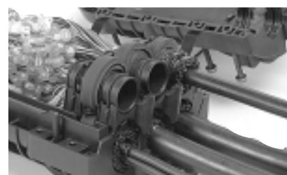
25 Вставьте кабели в нижнюю половину муфты и затяните пояски-стяжки. Убедитесь, что замок пояска-стяжки находится сверху. Обрежьте излишки пояска-стяжки.
