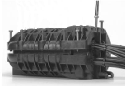
28 Затяните болты, начиная с двух длинных, а затем два болта возле тупиковой части муфты. Не затягивайте болты окончательно.
