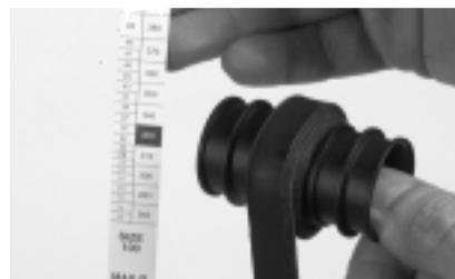
23 Зажимающая лента устанавливается поверх резиновой накладки, и гелевая лента устанавливается поверх гелевой накладки.
