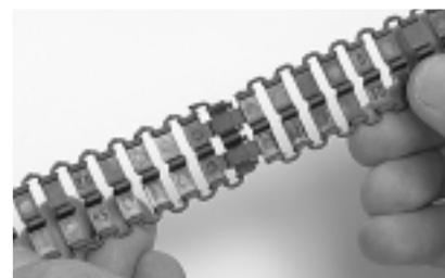
6 Если требуемая длина зажимающей ленты превышает 25 секций, две ленты могут быть соединены вместе так, чтобы обеспечить требуемое число секций.
