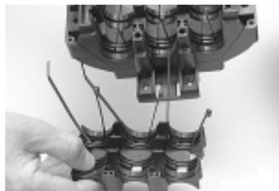
2 Установите пояски-стяжки в отверстиях на нижней половине муфты. Вставьте пояски-стяжки в разделители кабеля. Пояски-стяжки обеспечивают фиксацию кабеля и блокирующих заглушек в портах во время монтажа.
