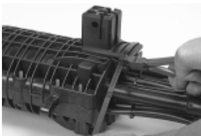
33 Крепёжный кронштейн (заказывается отдельно) устанавливается в нижней ребристой части муфты, как показано на рисунке. Широкий поясок-стяжка (не входит в состав комплекта) обеспечивает фиксацию крепёжного кронштейна на основании муфты. Затяните поясок-стяжку и отрежьте его излишек.
