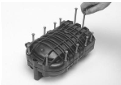
1 Вставьте болты с шайбами в верхний полукорпус муфты и поверните их на несколько оборотов так, чтобы они держались в крышке. Два длинных болта разместите в отверстиях над кабельными портами.
